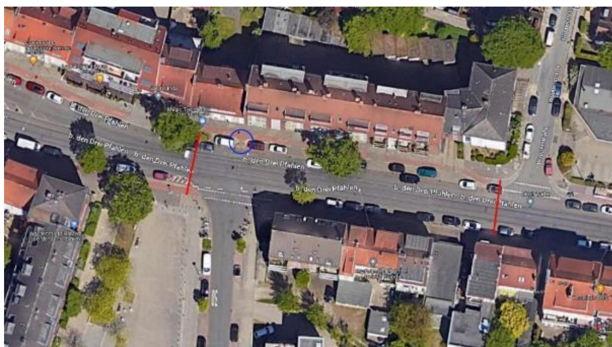
Abbildung 87: Rote Linien: Vorschläge für mögliche Querungshilfen. Blauer Kreis: angedeutete Querungshilfe für Fahrräder. Gut zu erkennen: Parken in zweiter Reihe auf der Straße Bei den drei Pfählen und (zum Aufnahmezeitpunkt nur geringfügig) zugeparkte Einmündung in die Wupperstraße sowie beidseitig aufgesetztes Parken in der Wupperstraße (Quelle: Google Maps, Kartengrundlage: © AeroWest, CNES / Airbus, GeoContent, Maxar Technologies, Kartendaten © 2023 GeoBasis-DE/BKG (© 2009)).
